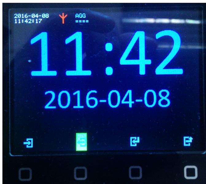
На экране отображается время и дата, состояние связи с AggreGate сервером, и иконки назначения кнопок (вход, выход, временный вход и временный выход) В зависимости от настроек кнопок, иконки могут отсутствовать (кнопка выключена), фоном подсвечена активная в данный момент функция. На данном примере контроллер находится в режиме выхода.
